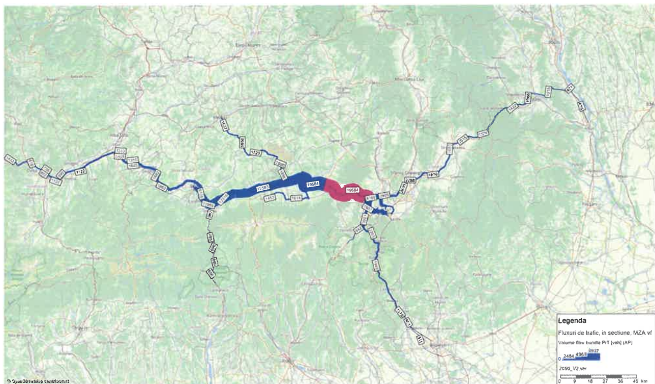
Figura 38. Relatii de trafic deservite de sectorul drumului expres (flow bundle) - Varianta 2 – Verde, la nivelul etapei de perspectiva 2050
